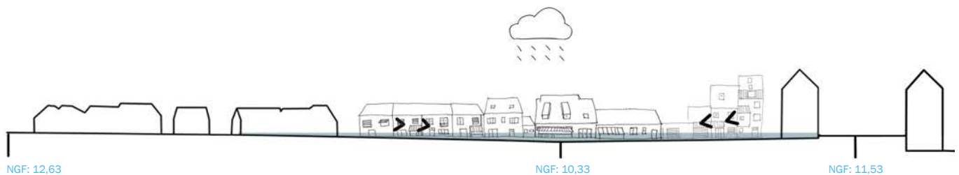
État existant : sol imperméable "effet cuvette"
