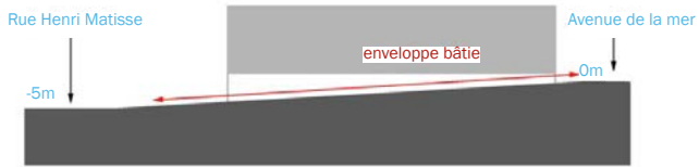
Création d'une rampe pour permettre la liaison entre l'avenue de la mer et la rue Henri Matisse
